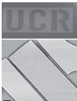
תמונת מיקרוסקופ אלקטרוני סרוק של התקן גרפן חדשני, המנצל שני לוגי לא-בוליאני (כאשר שמליל האוניברסיטה, UCR, מוטבע על גבי משטח הגרפן). קנה המידה של הקו בתחתית התמונה הוא מיקרון אחד (באדיבות University of California at Riverside).
