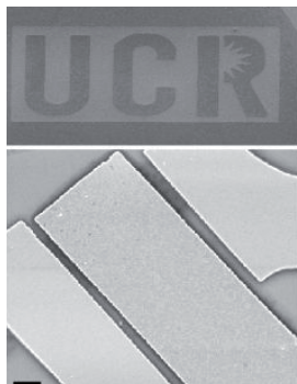
תמונת מיקרוסקופ אלקטרוני סורק של התקן הגרפן החדשני, המנצל שני לוגי לא-בוליאני (כאשר שמליל האוניברסיטה, UCR, מוטבע על גבי משטח הגרפן). קנה המידה של הקו בתחתית התמונה הוא מיקרון אחד (באדיבות University of California at Riverside).
